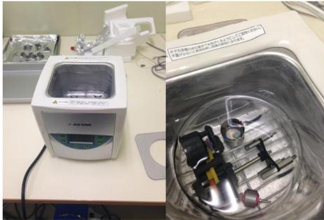
**Figura 23** Sistema de limpieza ultrasónico.
