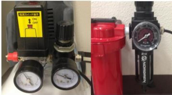
**Figura 13** Manómetros del sistema de alimentación de aire.
