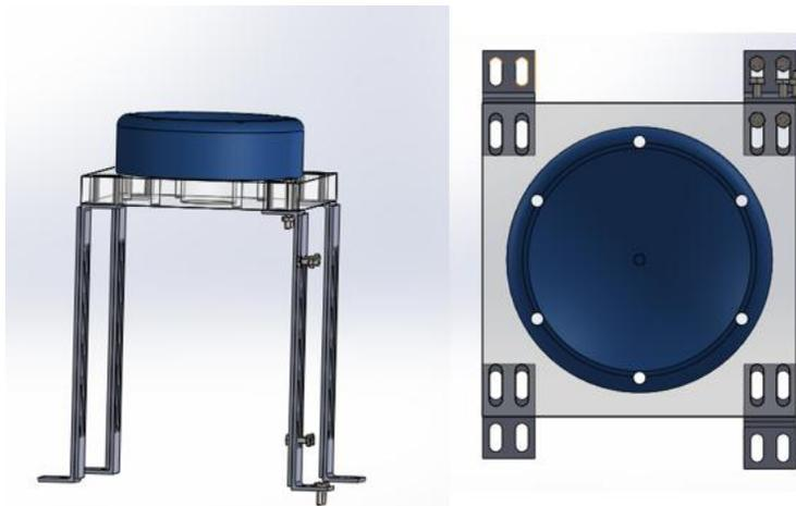
**Figura 25** Base del cojinete neumático a la cámara de vacío.
