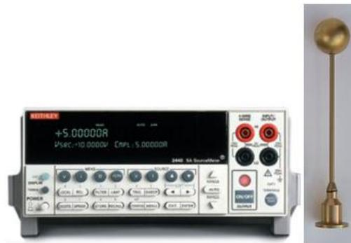
**Figura 29** Fuente de poder y probeta de Langmuir esférica.<sup>14</sup>
