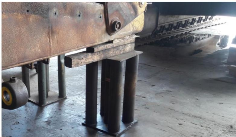
Figura 1. Forma incorrecta de calzar que genera condición insegura.
