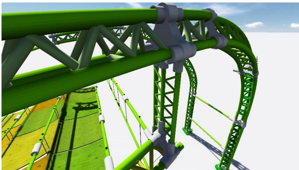
**Perspectiva de piezas de unión entre secciones del arco.**
