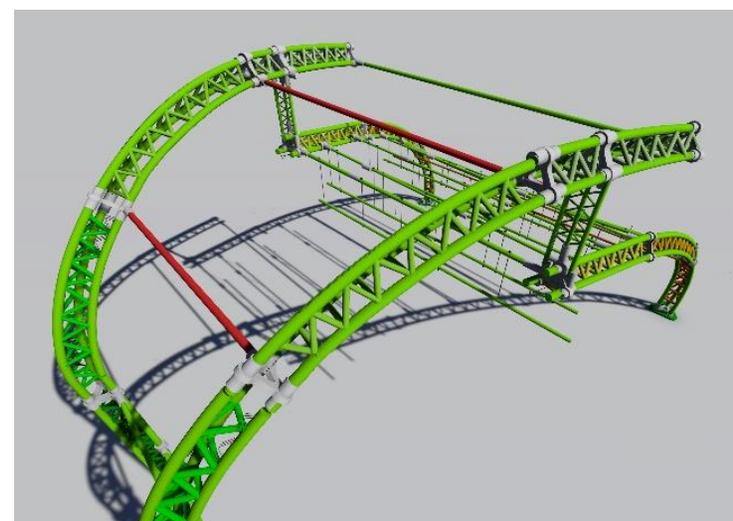
**Barras rojas de seguridad para el montaje luego son retiradas.**
