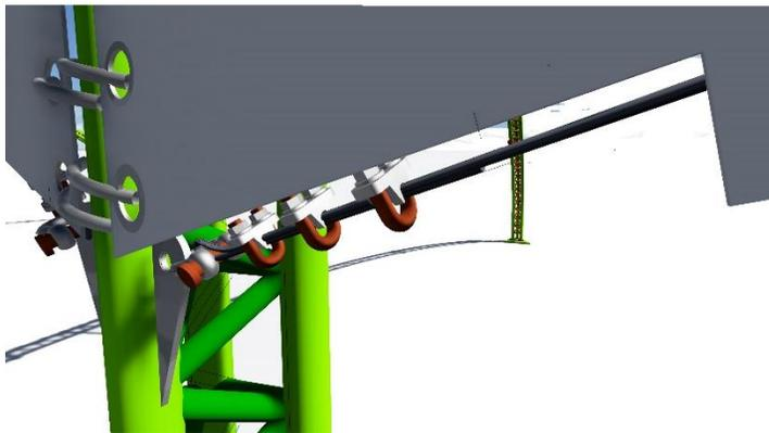
**Detalle de unión de tensor hacia placa de acero soldada al tubo de la sección del arco.**
