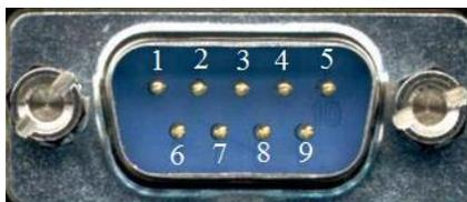
**Figura 3.12** Conector DB9 utilizado para la interfaz RS-232
