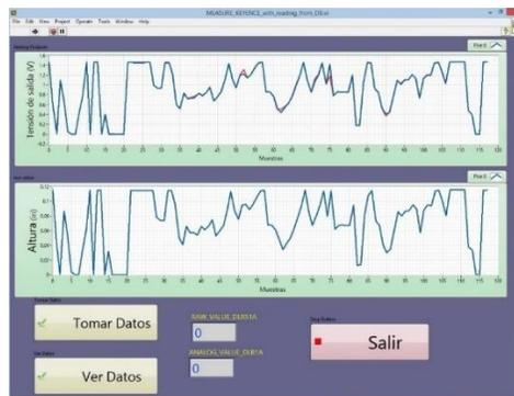
**Figura 6.10** Interfaz gráfica de medición remota del sensor de detección láser de barrera Keyence IB-Series a través de comunicación serial RS-232 y un DAQ LabJack
