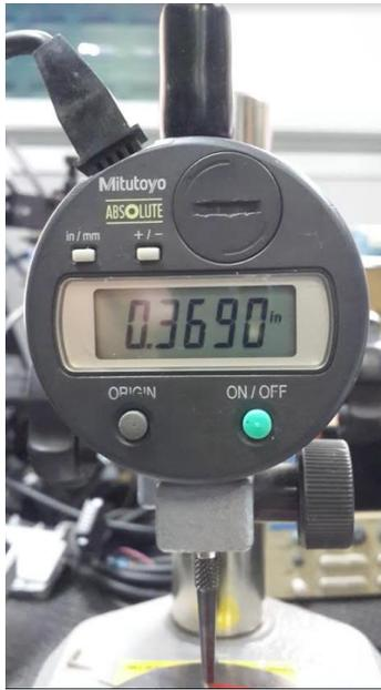
**Figura 6.5** Medición de una muestra en el Indicador de altura Mitutoyo ABSOLUTE Digimatic
