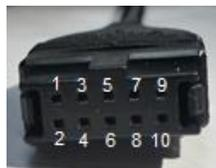
**Figura 3.16** Conector del lado de la interfaz del cable Mitutoyo 905338
