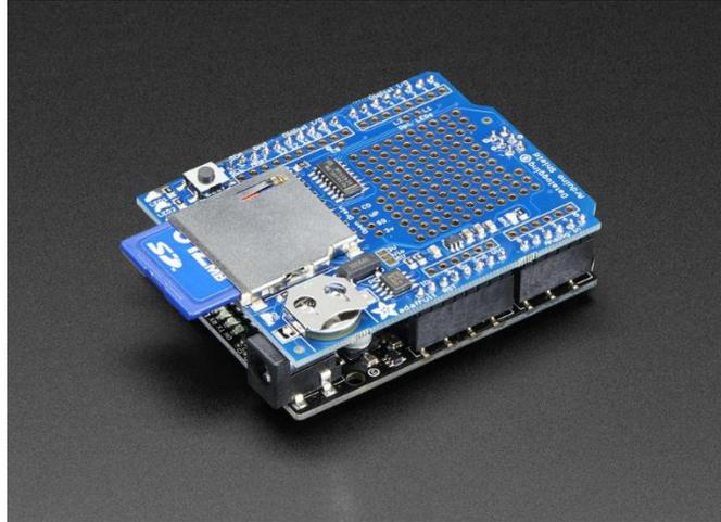
Figura A.2.9 Diagrama de la conexión del shield data logger con el arduino, tomado de [25]
