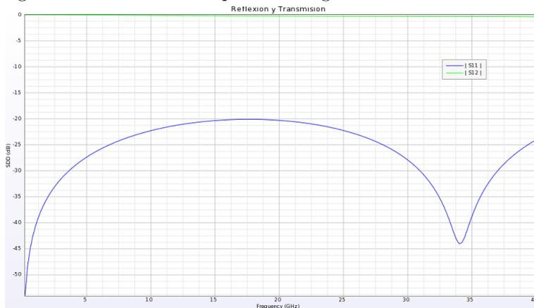
Figura 3.10: Transmisión(S12) y reflexión(S11) de la línea microstrip
