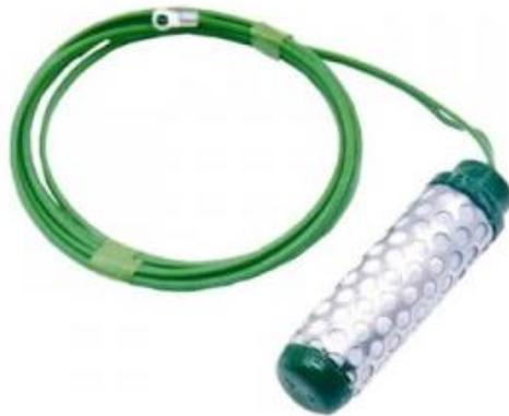
Figura 7. Sensor granular, tomado de [7]
