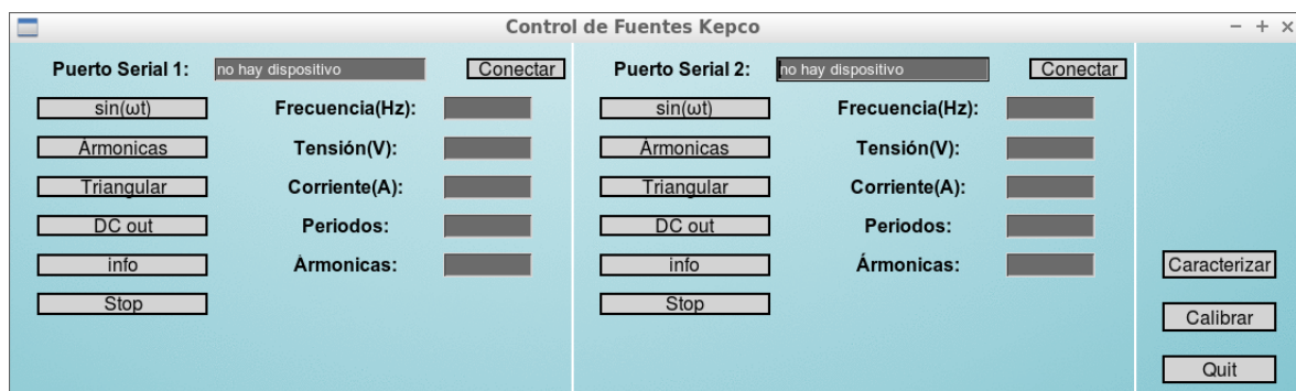
Figura 3.7: Interfaz de usuario para el control simultáneo de dos fuentes Kepco
