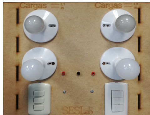
Figura 4.5: Panel de cargas con elementos de iluminación y puertos para conectar diferentes cargas.
