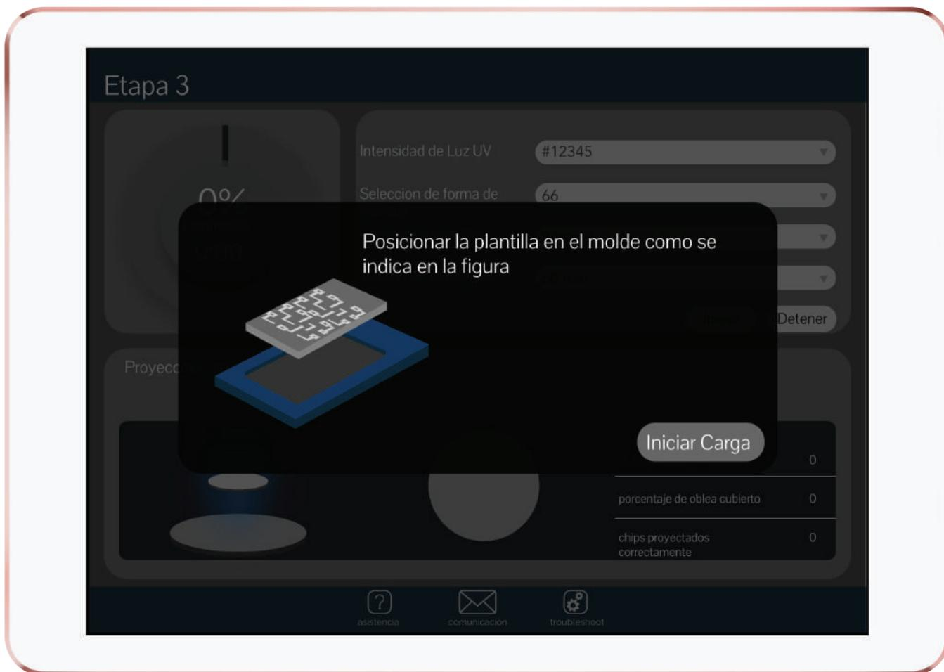
Mediante la interfaz se indica de forma correcta como cargar la plantilla en la máquina o bandeja en caso de no estar para que la misma pueda ser cargada dentro del proyector.
