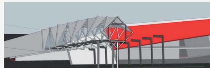
Protección de la luz solar y regulación de la iluminación que accede al interior mediante el uso de parasoles en las fachadas principales de ambos edificios, lo cual permite una reducción de la cantidad de luz que ingresa por la mañana y tarde.
