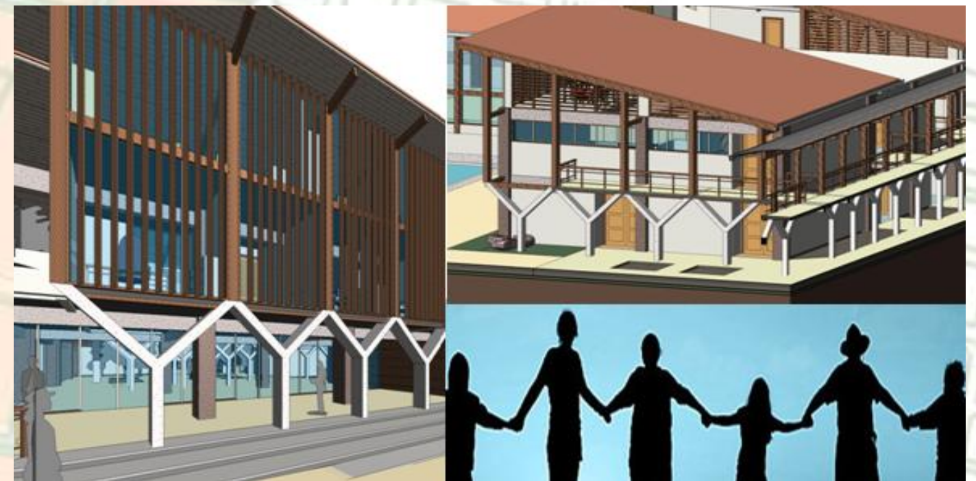
Figura #153. Detalle de columnas en madera laminada y de concreto en forma de "y". Fuente: propia.
