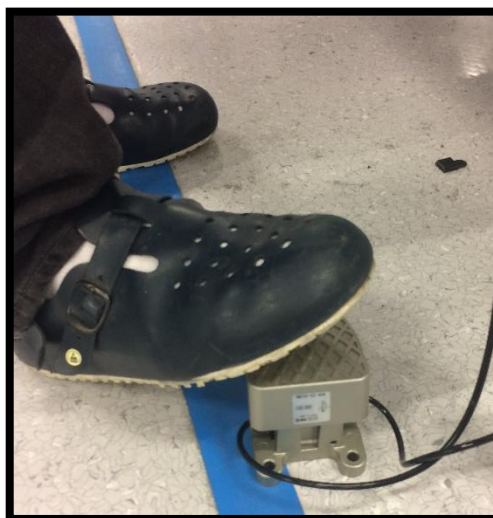
Figura 4. Pedal para el paso de aire comprimido.
