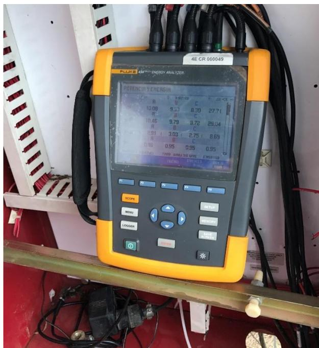
Figura 25. Registrador Trifásico FLUKE 434-II
