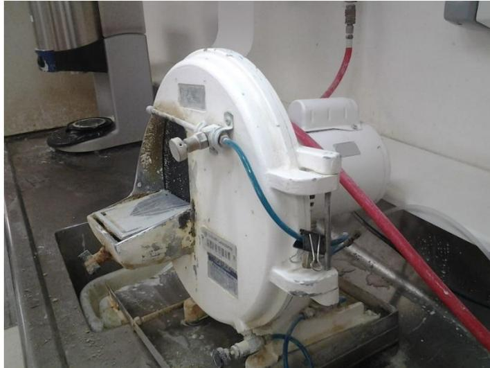
**Figura 37. Recortadora de modelos**
