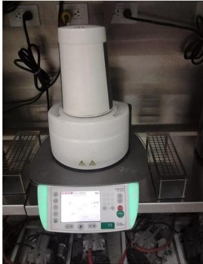
**Figura 29. Horno de prensado**
