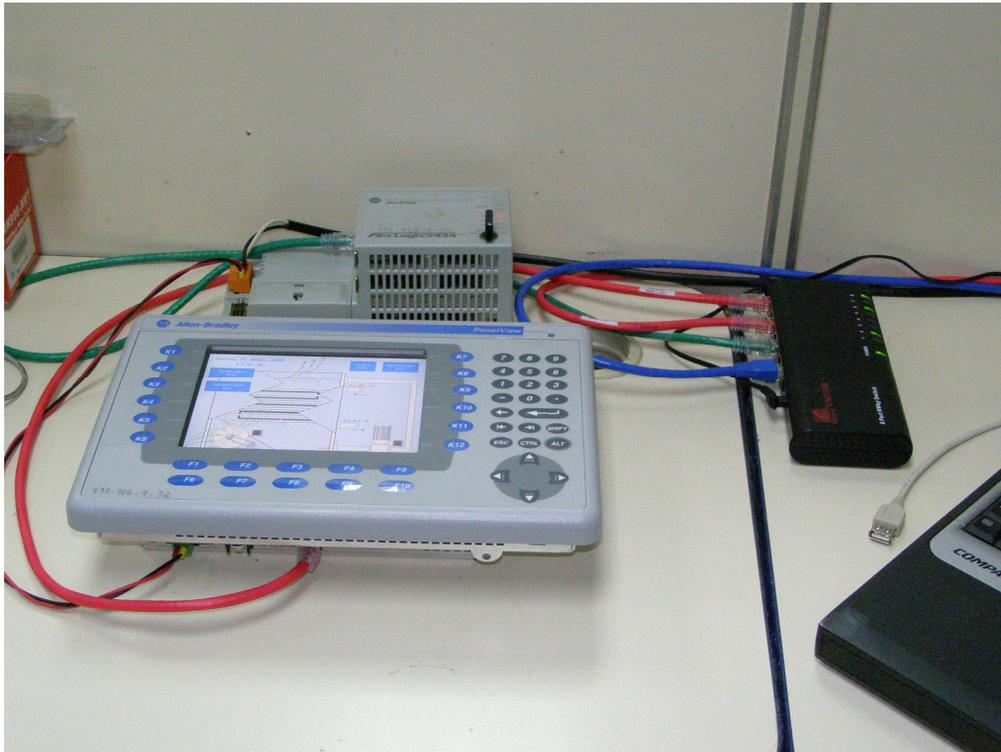
**Figura 4.12.** Controlador, etapa de visualización y red Ethernet
