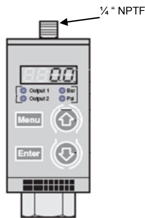
Figura 5.2. Sensor de presión Nautilus XMLF-010D2026. [12]
