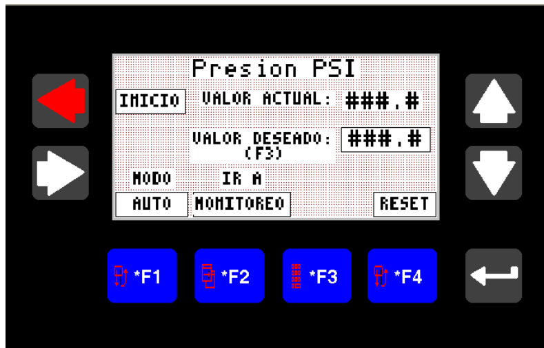
Figura 6.2. Pantalla Control Automático.
