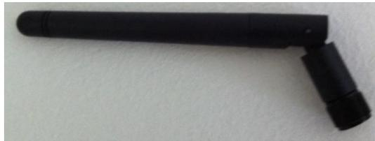
**Figura 4.42 Antena de monopolo acoplada a los transmisores**
