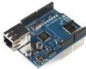
Figura 4.49 Controlador Ethernet W5100 empotrado en un escudo de Internet para Arduino
