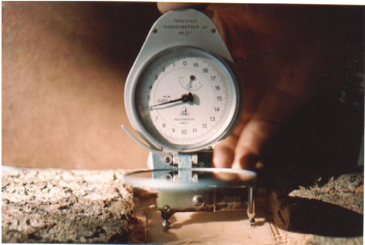
Figura 6. Extensómetro (Hugenberger tensotast) utilizado durante el trabajo de campo. Guanacaste, 2001.
