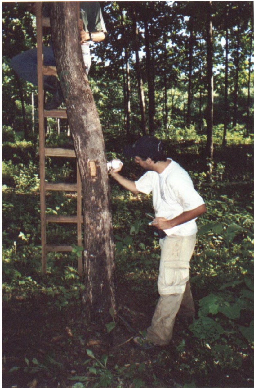
Figura 5. Demostración de la medición de las tensiones de crecimiento con un extensómetro a 1,3 m de altura. Guanacaste, 2001.
