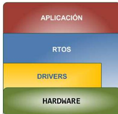
Figura 5.1: Capas del sistema embebido.
