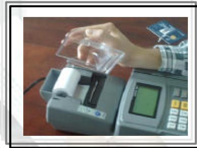
**Figura 6.** Procedimiento para remover el papel continuo.
