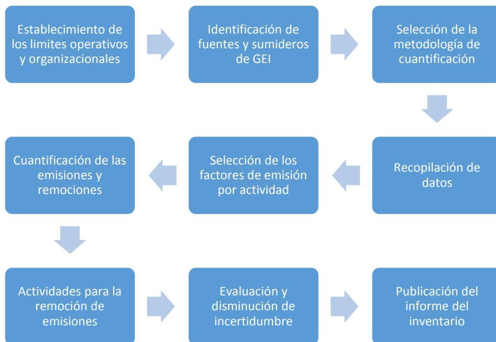
Figura.2.6. Procedimiento para la aplicación de la norma ISO 14064-1. Fuente (ISO, 2006)
