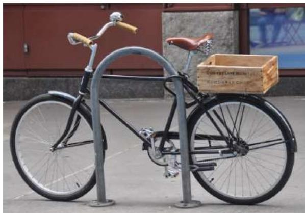
**Figura 4.** Ejemplo de estacionamiento de bicicletas recomendado tipo U invertida
