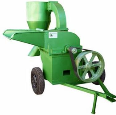
**Figura 5.8.** Molino Martillo para el procesamiento de la biomasa (Tomado de Maquinaria Agrícola, 2017).
