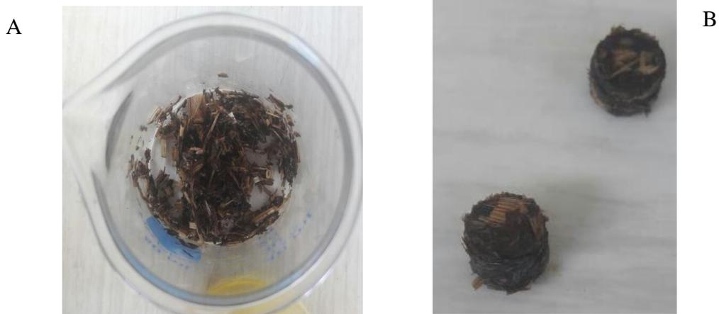
**Figura 5.6.** Mezcla de biomasa e hidrocarburos (A), muestras listas para la medición (B) de la prueba de poder calórico.
