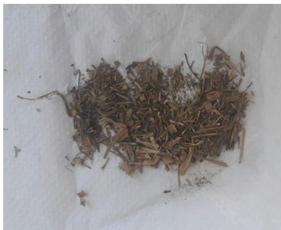
**Figura 5.5.** Biomasa empleada para la prueba de calorimetría.
