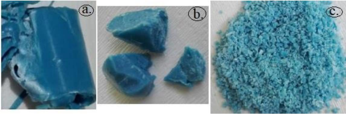
Figura 4.3 Mezcla en distintos puntos del proceso a. mezclado en mezclador (tipo Brabender), b. partido con cuchilla y c. molido.
