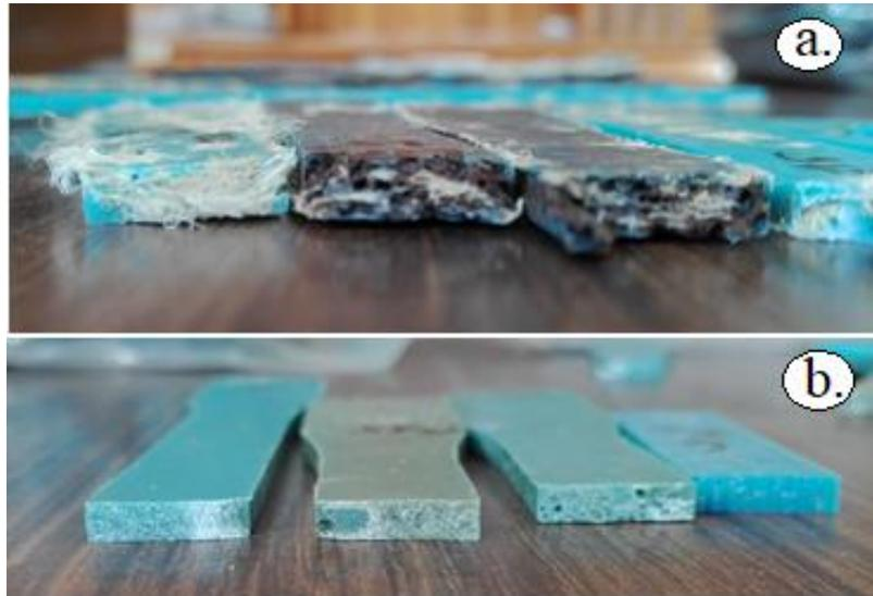
Figura A.2.1 Punto de falla en a. pruebas preliminares, b. tratamientos con fibra corta.
