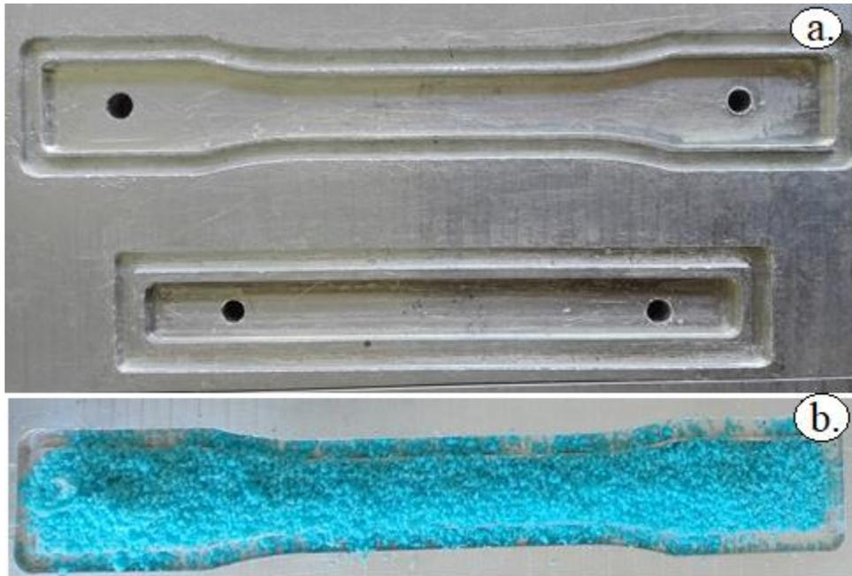
Figura 4.4 a. Molde de aluminio utilizado, b. PLA en el molde antes de la termo formación.
