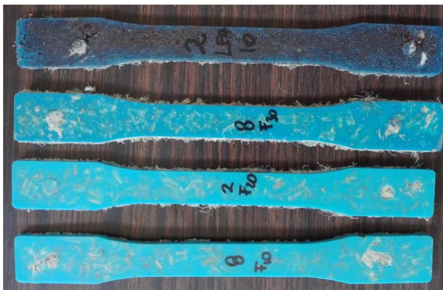
**Figura 5.1 Probetas con fibra larga y lignina según código.**
