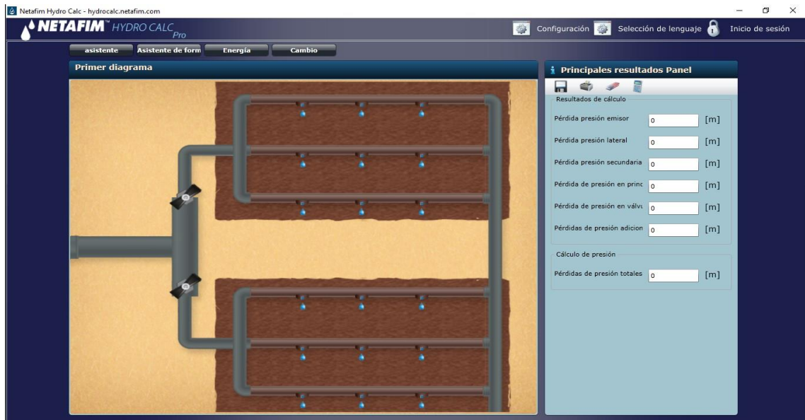
FIGURA 13 INTERFAZ DEL HYDRO CALC
