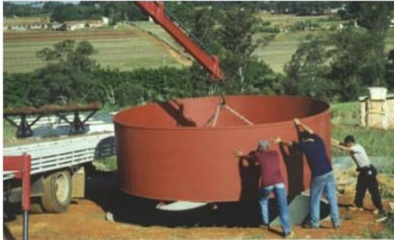
Figura 6. Momento de instalación en campo de un lisímetro.
