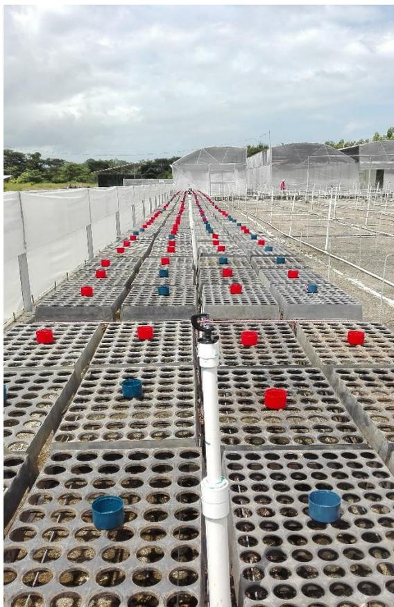
**Figura 2.** Distribución espacial de los contenedores para la recolección de agua rociada durante la prueba de riego en el invernadero de Panamerican Woods 2017.
