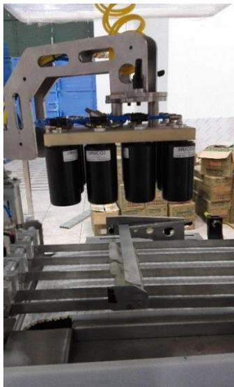
*Ilustración 20.* Grippers (8 botellas). Adaptado de la Gerencia de Operaciones de Ficmams, octubre 2017.
