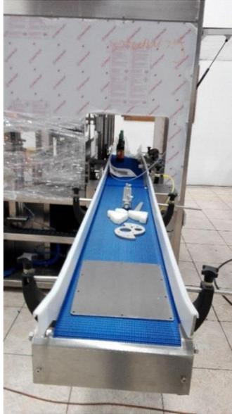
*Ilustración 21.* Banda de salida de cajas para botellas. Adaptado de la Gerencia de Operaciones de Ficmams, octubre 2017.
