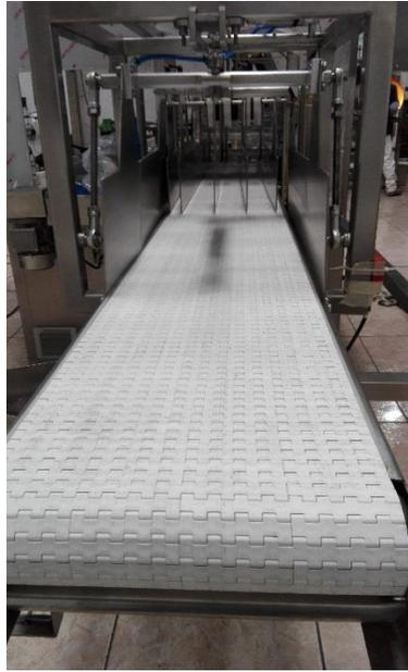
*Ilustración 19.* Banda acumulativa de botellas. Adaptado de la Gerencia de Operaciones de Ficmams, octubre 2017.
