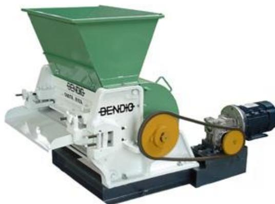
Figura 24. Máquina despulpadora.
