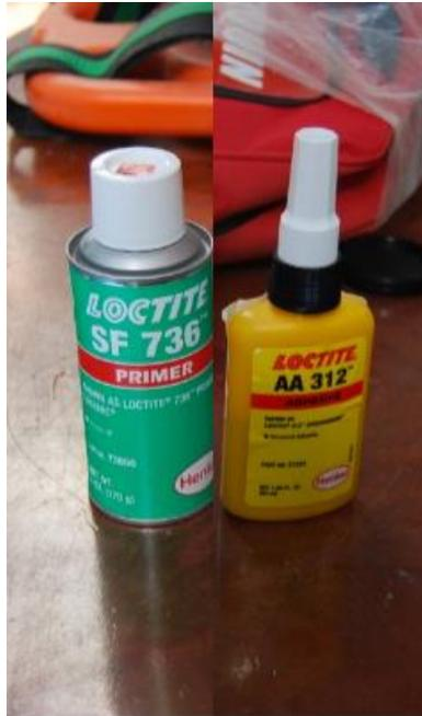
Figura 4.22 Adhesivo AA 312 y activador SF 376 loctite.
