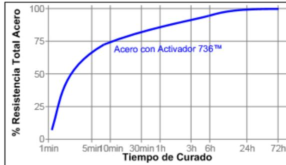
Figura 4.23 Velocidad de curado según el sustrato adhesivo AA 312 loctite.
