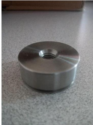
Figura 4.17 Bases para Acelerómetros de acero inoxidable 302.
