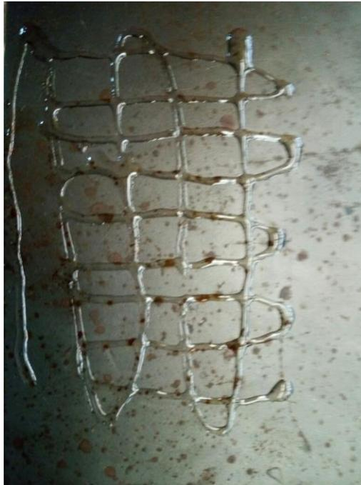
Figura 6.28 Distribución del adhesivo en la lámina de acero 1020.
