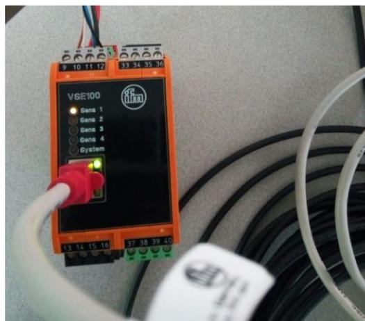
Figura 6.13 Reacción de la electrónica de monitoreo para corroboración de comunicación.
