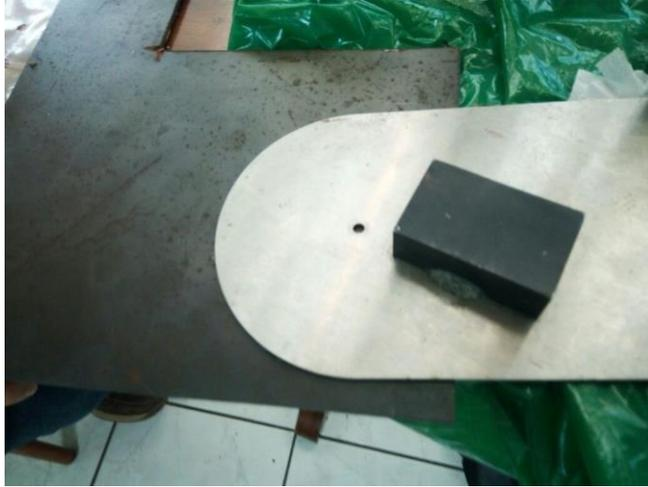
Figura 6.29 Láminas unidas mediante adhesivo AA 312 loctite.
