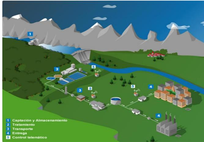
**Figura 3.1-1 Esquema general de un sistema de abastecimiento de agua potable, tomado de diseño de acueductos. Tomado de Torres (2008)**
