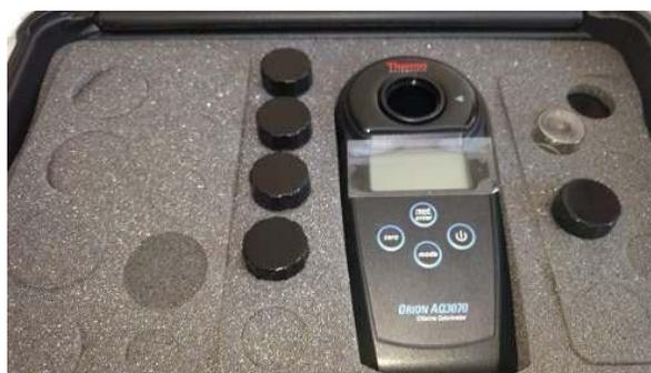
Figura 6.1-2. Medidor de Cloro utilizado para la elaboración de la curva de cloro para las muestras de agua de Amubri, marca Orión
