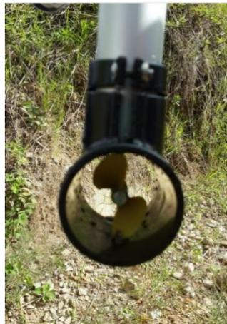
**Figura 5.2-7. Molinete Telescópico utilizado en la gira de campo. Marca Global y Watery modelo FP211**
