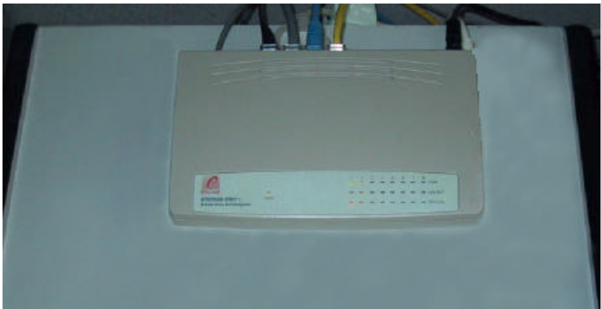
Figura 7.1.1 Dispositivo de red utilizado para la implementación de la red A9800, un hub Encore ENH908 NWY.
