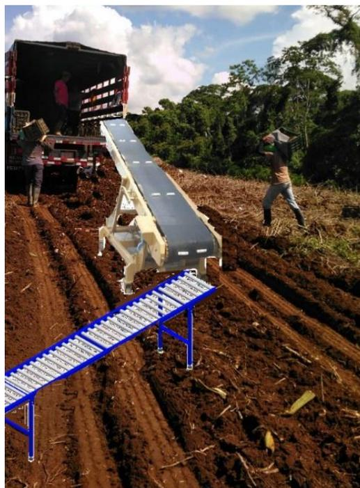
Figura V.VII. Imagen representativa del nuevo sistema de trabajo para la carga del camión,
