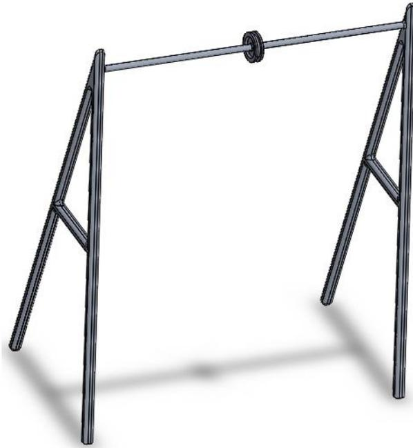
Figura V.IV. Herramienta manual para el pesado de cestas vista isométrica.
