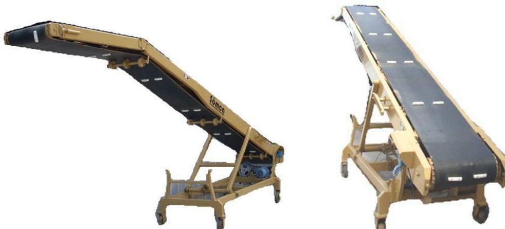
Figura V.VI. Cinta transportadora para carga y descarga de camiones con elevación automática
