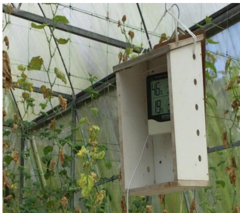
Figura 4. Sensor de temperatura y humedad Extech® Instruments a Flir Company 445713 instalado en el interior del invernadero para medir las variables ambientales durante el proyecto de investigación de tres cultivares de pepino ( Cucumis sativus . L) bajo ambiente protegido en sistema hidropónico con dos soluciones nutritivas en San Carlos, Costa Rica 2015-2016.
