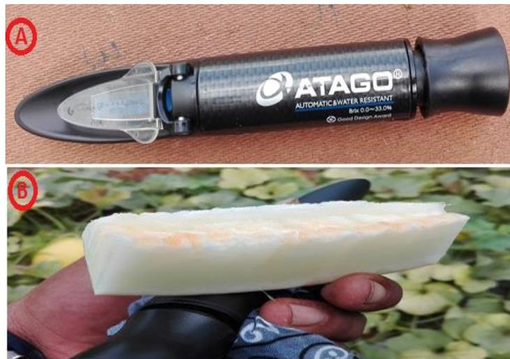
Figura 6: A) Refractómetro utilizado para medir la concentración de sólidos solubles totales (Grados Brix) al momento de cosecha. B) Parte del fruto utilizado para medir los grados Brix al momento de la cosecha.
