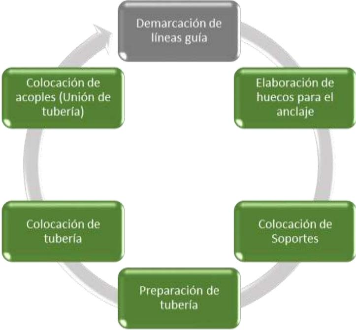
Figura 42. Diagrama del proceso de colocación del sistema de supresión de incendios. ( Creado en Microsoft Word 2013).
