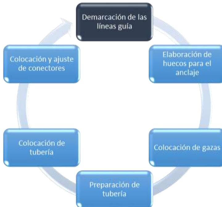
**Figura 14.** Diagrama del proceso de canalización del sistema de tomacorrientes e iluminación.(Creado en Microsoft Word 2013).
