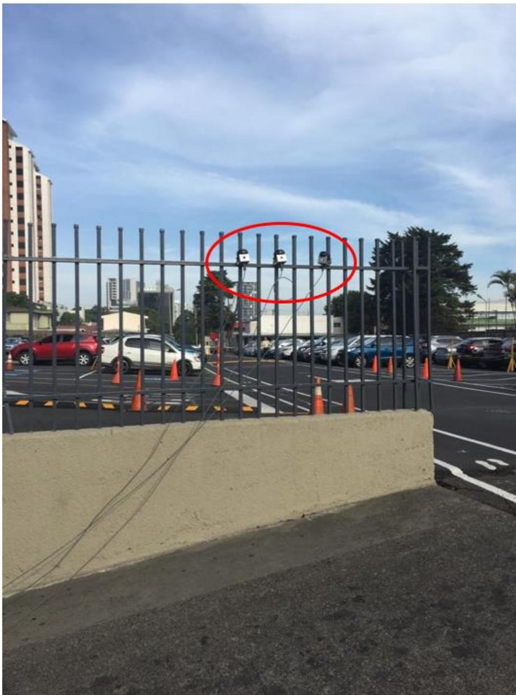
Antenas de GPS para la sincronización de tiempo de los acelerógrafos
