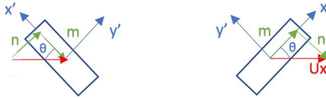
Observando las figuras anteriores, al tener 2 elementos rotados (como en el ejemplo) las componentes paralelas a  $y'$  de la fuerza o desplazamiento aplicado, van a tender a hacer rotar la planta. Esto a pesar de que la fuerza o desplazamiento solo se está aplicando en el sentido X, de manera que va a haber una rotación con respecto a un punto que no coincide con el centro geométrico de la planta, que es precisamente el centro de rigidez.
