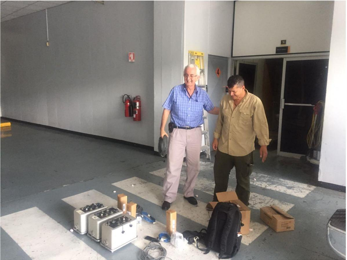
Preparación de acelerógrafos para las pruebas de vibración ambiental
