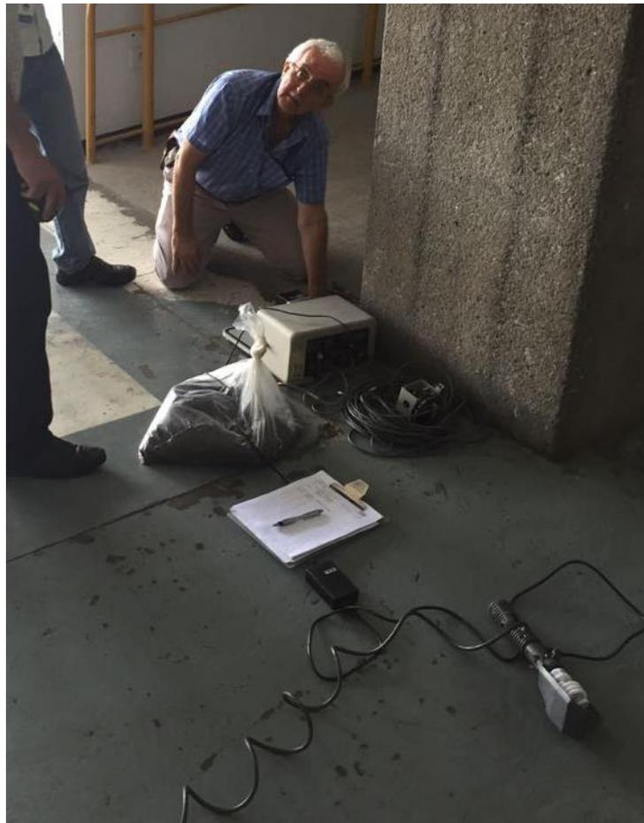
Ubicación y preparación de acelerógrafo en el sótano para perfil 1
