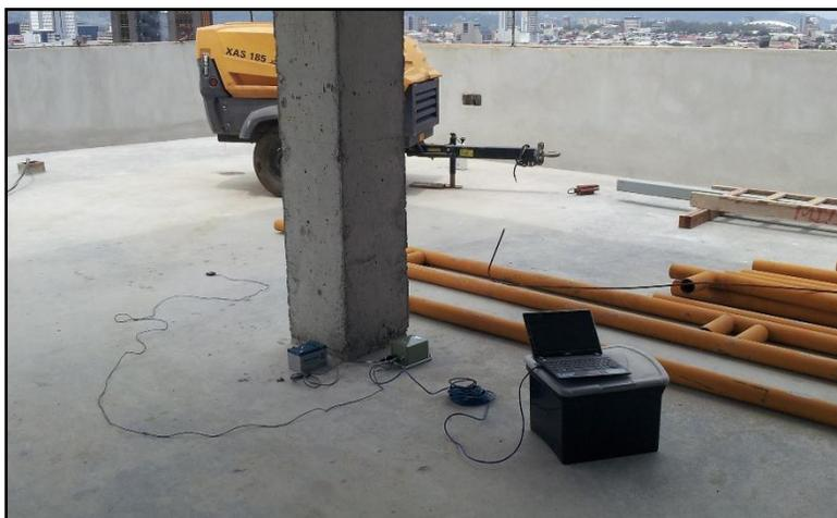
**Figura 3:** Acelerógrafo Nanometrics TitanSMA con accesorios, instrumentación temporal
