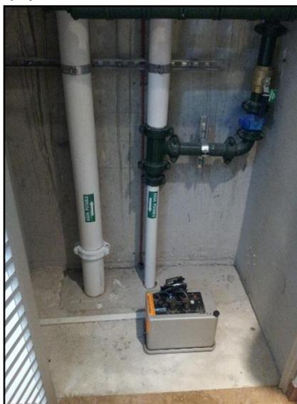
**Figura 4:** Acelerógrafo Reftek 130-SMA, instrumentación permanente.
