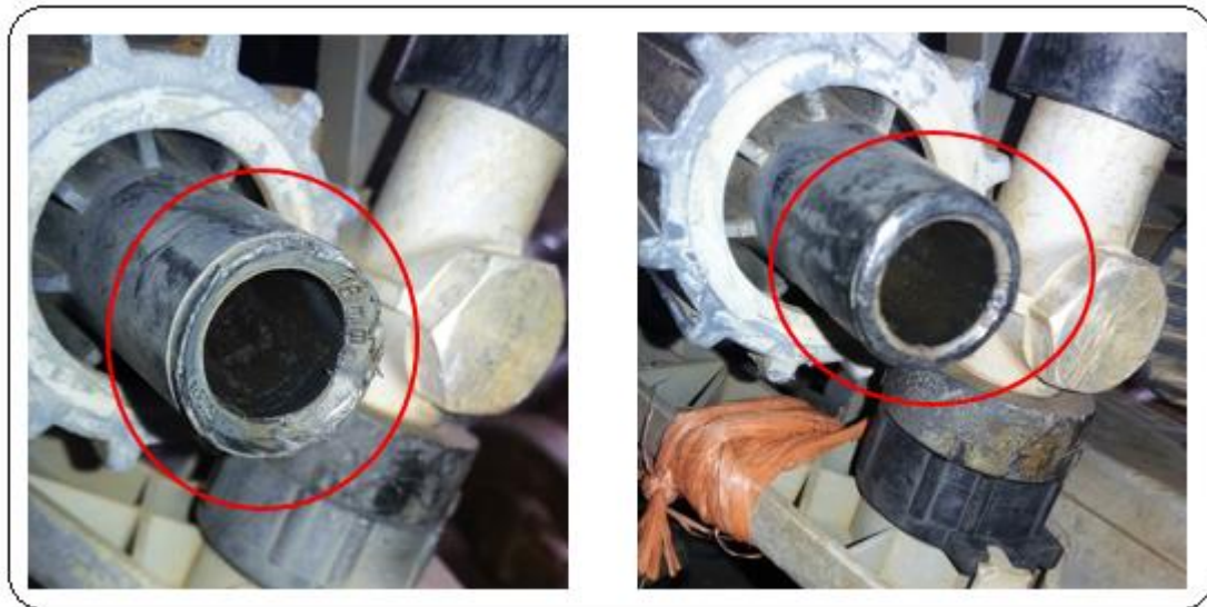
Fotografía 7. Boquillas golpeadas o desgastadas Fuente: Elaboración propia, 2017
