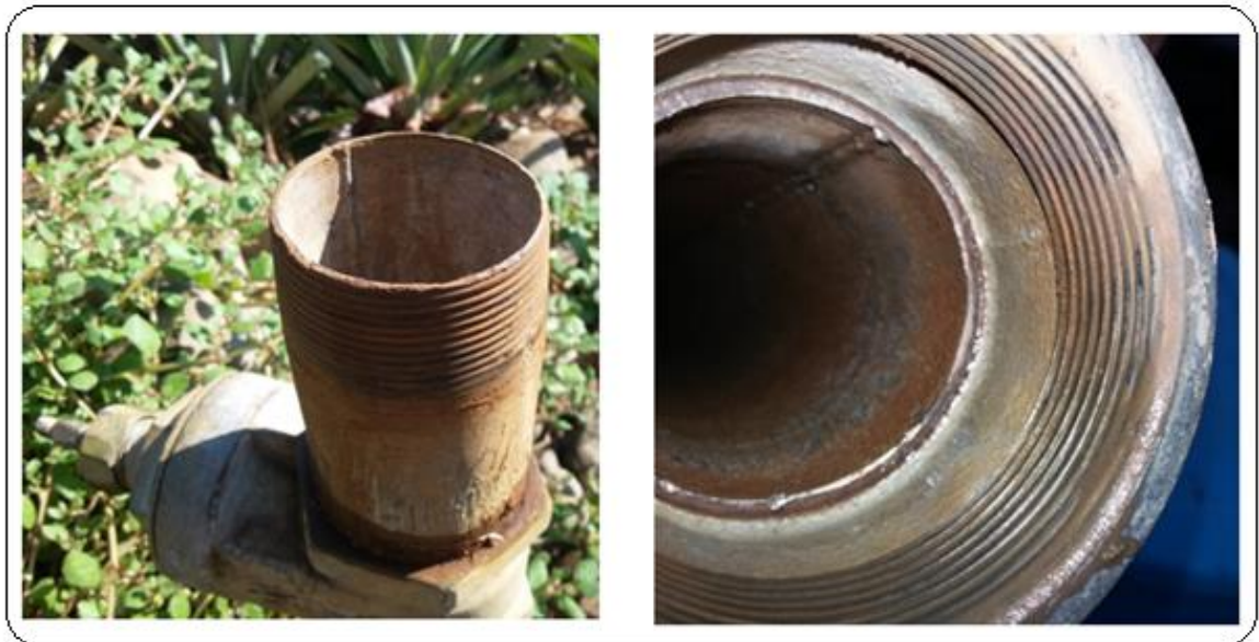
Fotografía 9. Desgaste en el adaptador hembra y adaptador macho de los elevadores Fuente: Elaboración propia, 2017
