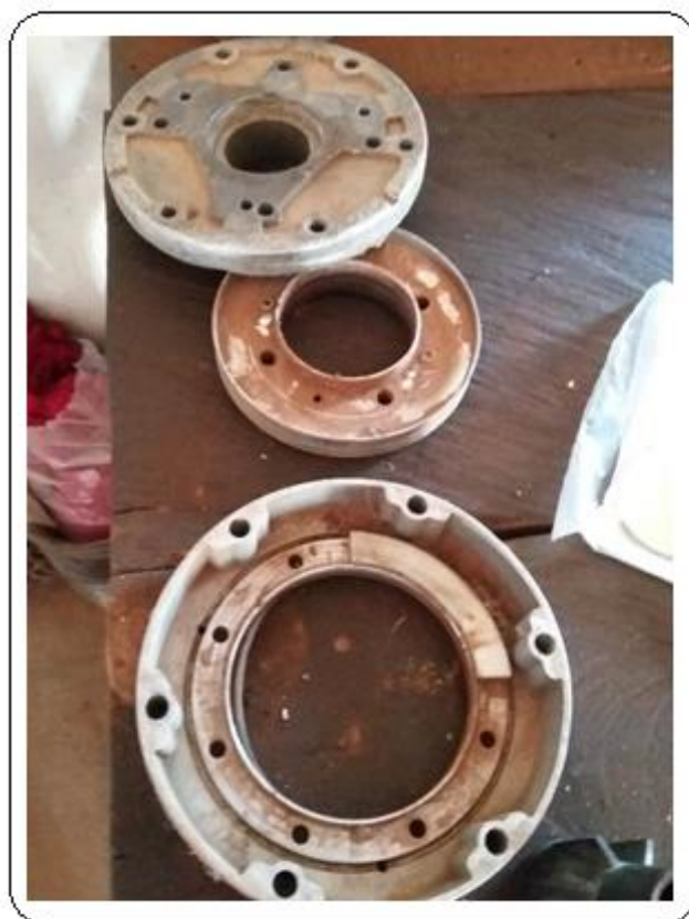
Fotografía 8. Desgaste en los discos Fuente: Elaboración propia, 2017
