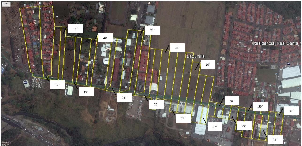
Figura 10. Áreas tributarias de la subcuenca correspondientes al Tramo 3' del sistema de alcantarillado pluvial. Fuente. El Autor.
