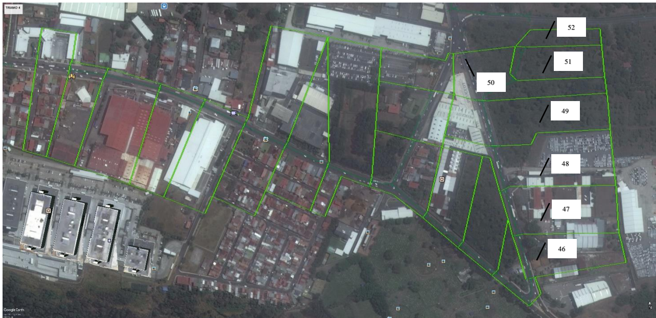
Figura 12. Áreas tributarias de la subcuenca correspondientes al Tramo 4' del sistema de alcantarillado pluvial. Fuente. El Autor.
