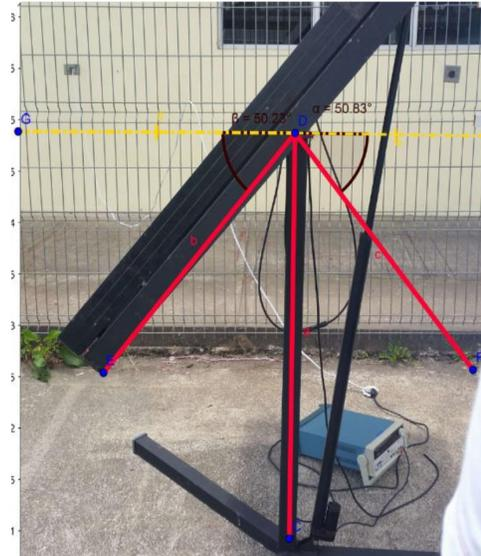
Figura 8: Estructura de montaje seguido solar. Las líneas rojas indican los ángulos de excursión de la estructura.
