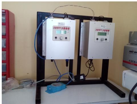
Figura 12: Caracterizador de módulos fotovoltaicos MPPT3000
