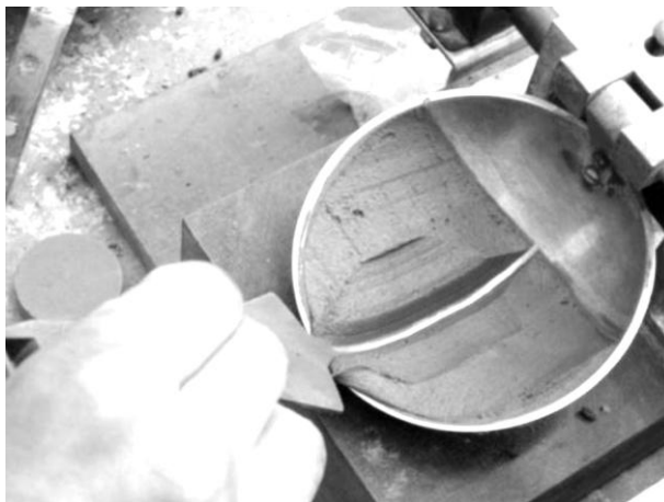
Figura 102: Suelo nivelado y corte definido en el aparato de Casagrande (Estudios Geotécnicos, 2013)
