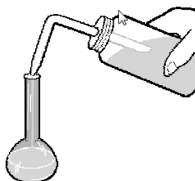
Figura 40: Llenado con agua destilada con una pipeta hasta el punto de calibración
