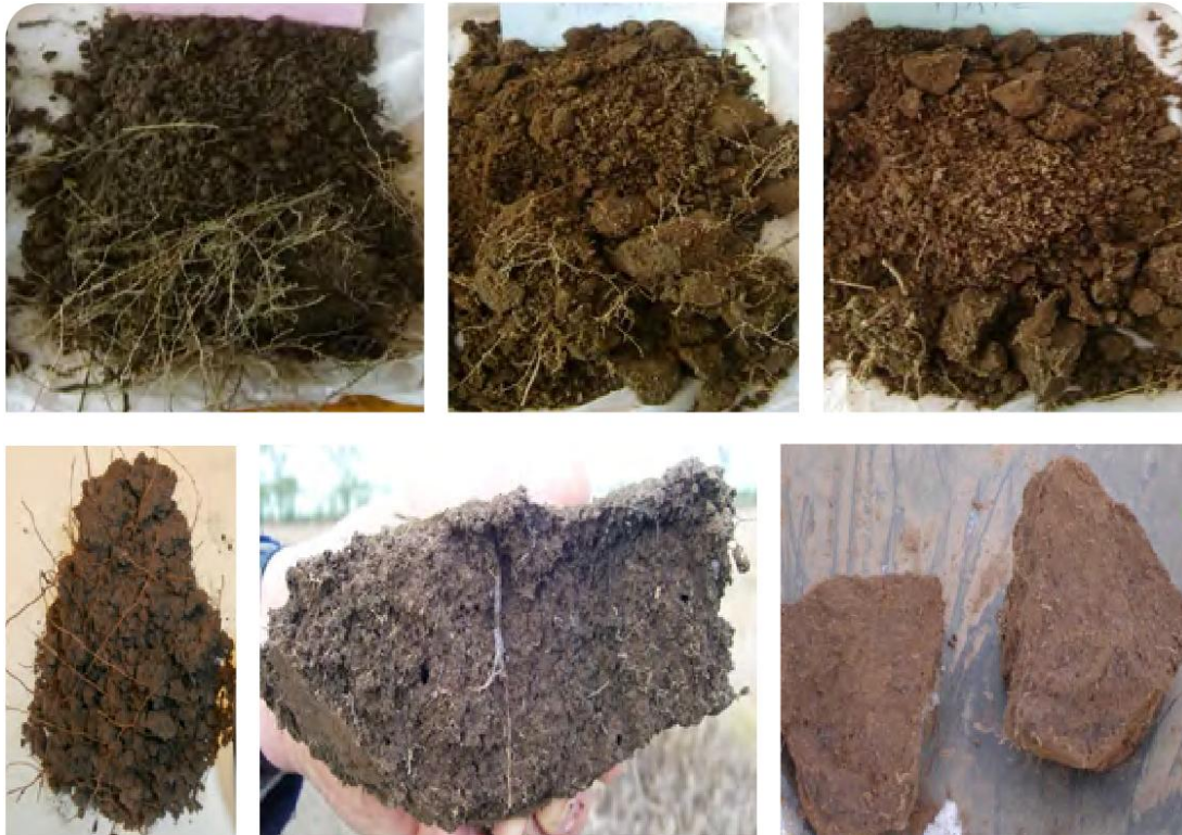
Figura 83: Condición buena, moderada y pobre porosidad (de izquierda a derecha) Tomado, de: (Álvarez, Leizica, & Gómez, 2021) Tomado de: (Benites Jump, 2014)
