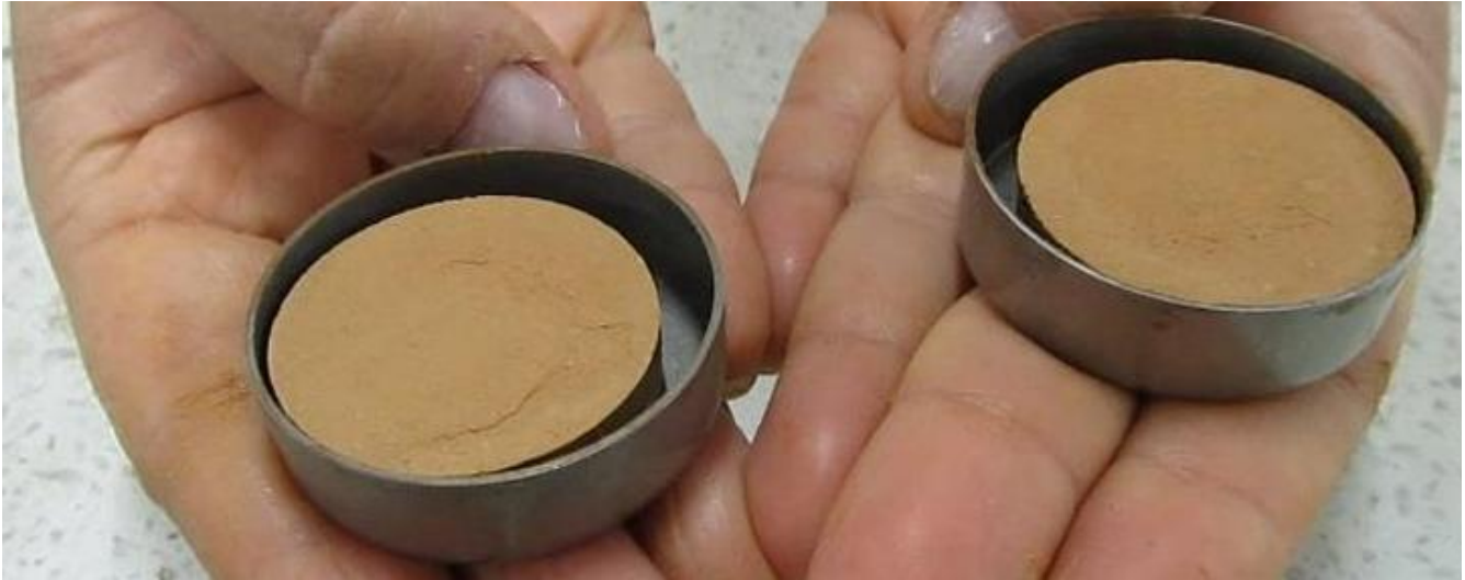
Figura 115: Contracción del suelo por pérdida de humedad
