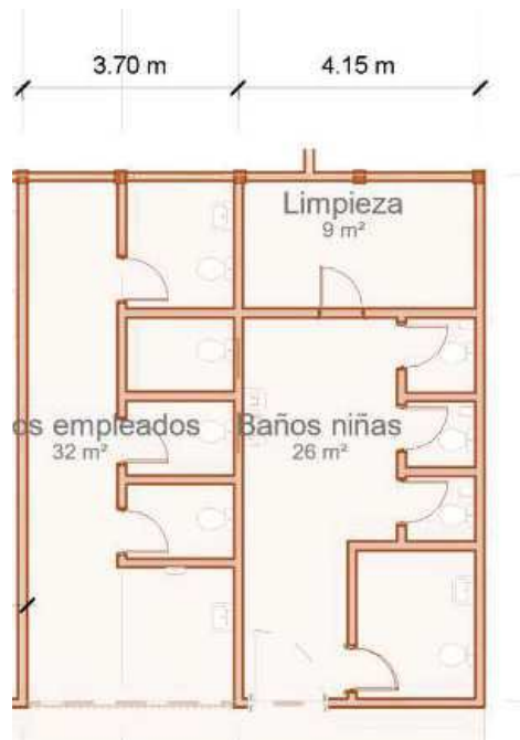
Figura 81. Planta baños | Fuente: Elaboración propia
