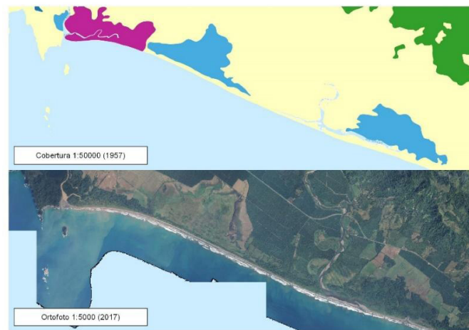
Figura 9. Error de clasificación de un manglar por un humedal en la hoja Quepos 1:50 000
