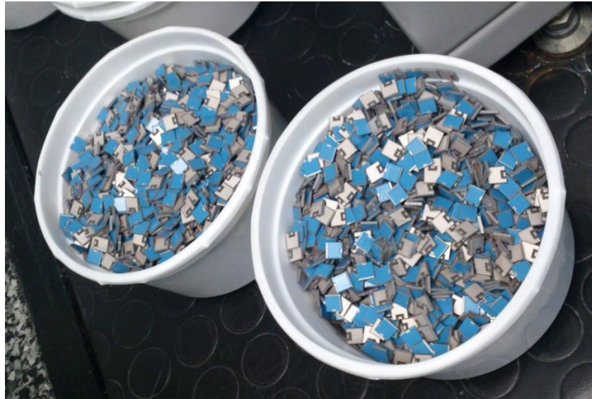
Figura 3.3 Encapsulados electrónicos listos para ser sometidos a galvanoplastia en EMC.
