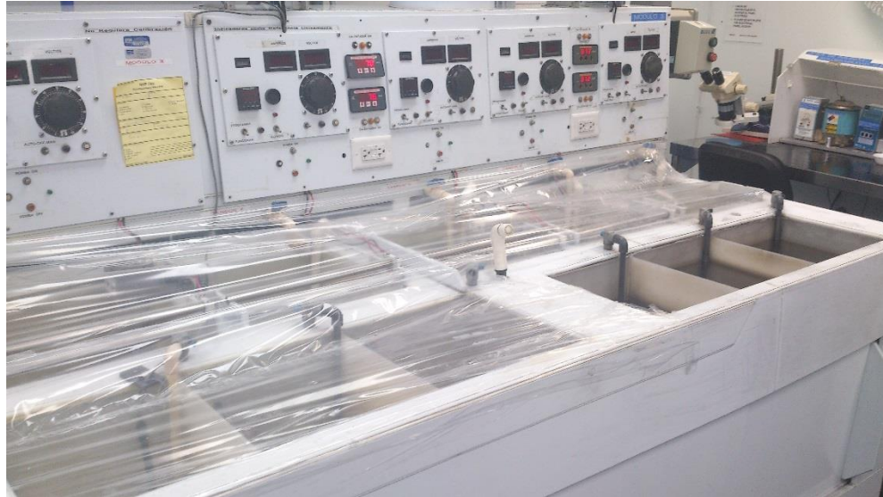
Figura 1.1 Tanques para galvanoplastia sin uso en EMC Technology.
