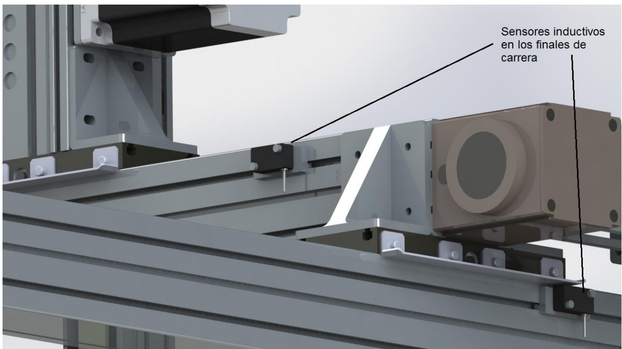
Figura 5.21 Ubicación de sensores de proximidad Unitronic A DIN 46335 usado en los módulos lineales. Elaborado en SolidWorks 2013 ®.
