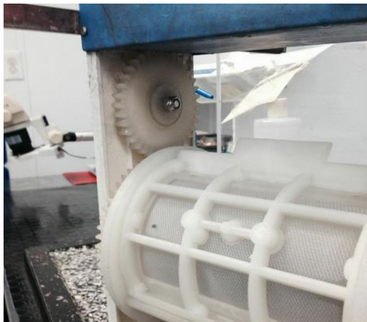
Figura 3.7 Sistema de rotación de los barriles en EMC.
