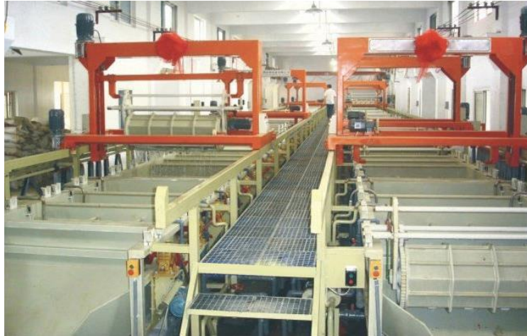
Figura 3.8 Maquinaria tipo pórtico para galvanoplastia en la industria [26].
