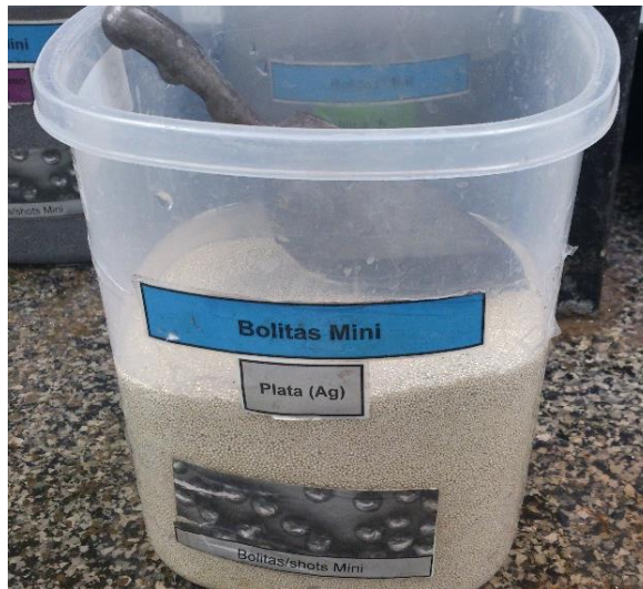
Figura 3.5 Esferas pequeñas de plata para propiciar el contacto eléctrico.
