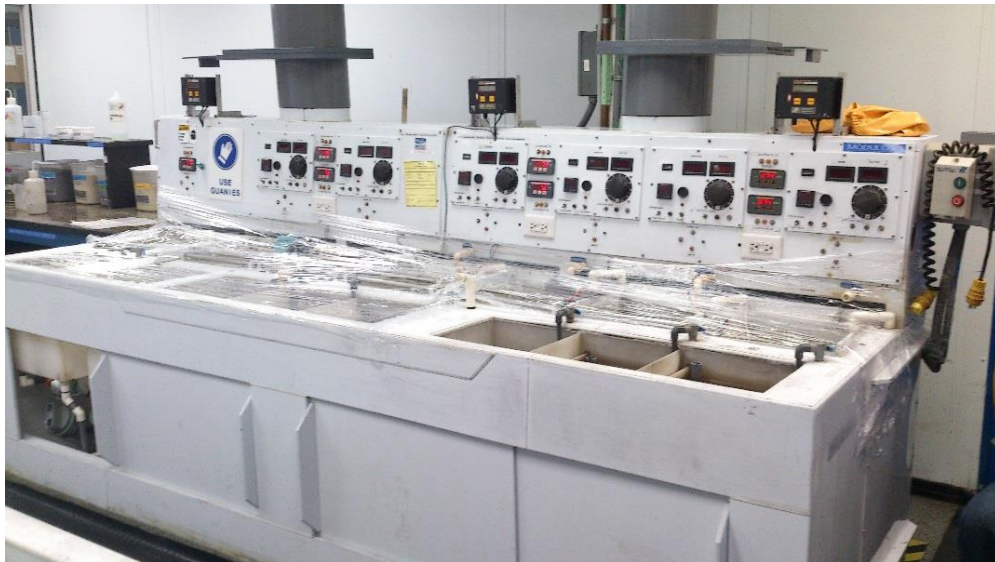
Figura 3.2 Módulo para galvanoplastia actualmente sin uso en EMC Technology.
