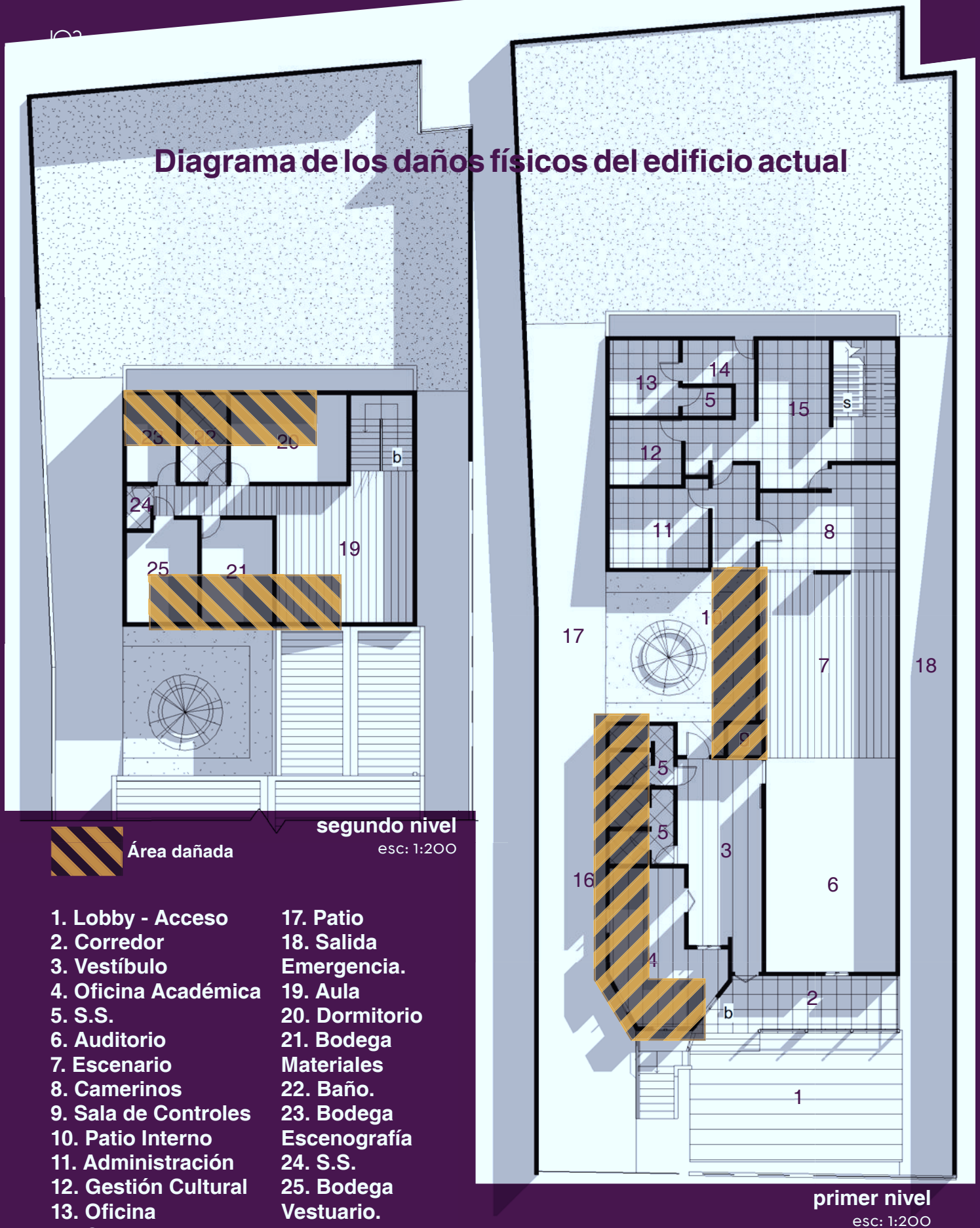
Figura 4-7. Diagrama de los daños físicos del edificio actual. Plantas arquitectónicas a escala 1:200
