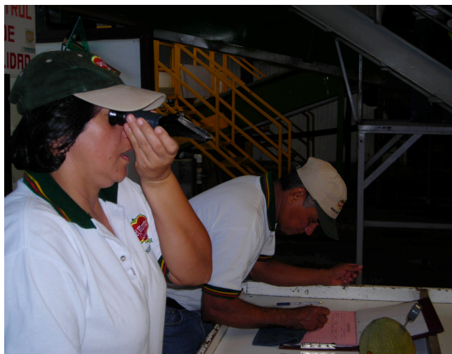
Figura 25. Lectura de SST con refractómetro de mano para melón ( C. melo ) variedad Cantaloupe. Planta empacadora de la Finca Melones de Costa Rica 1. Bagaces, Guanacaste. Temporada 2005-2006.
