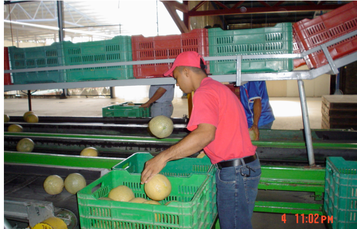
Figura 30. Proceso de selección por tamaño y calidad de melón ( C. melo ) al paso por las bandas transportadoras. Planta empacadora de la finca Melones de Costa Rica 1. Bagaces, Guanacaste. Temporada 2005-2006.
