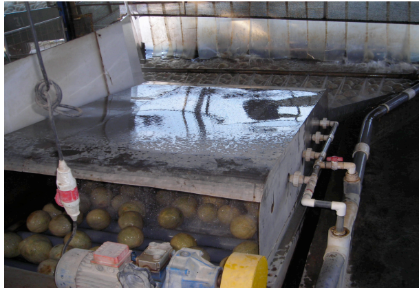
Figura 21. Pila de desinfección del melón ( C. melo ) variedad Cantaloupe. Planta empacadora de la Finca Melones de Costa Rica 1. Bagaces, Guanacaste. Temporada 2005-2006.
