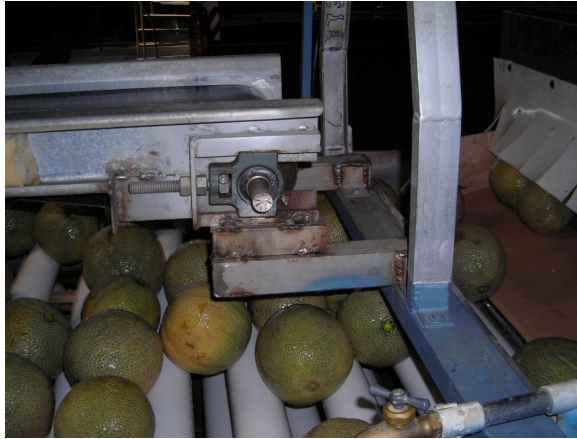
Figura 29. Paso del melón ( C. melo ) variedad Cantaloupe hacia la segunda banda de selección. Planta empacadora de la Finca Melones de Costa Rica 1. Bagaces, Guanacaste. Temporada 2005-2006.
