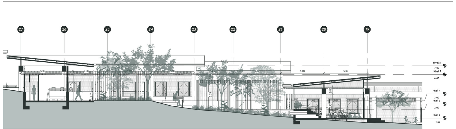
Bloque de Hospedaje Corte Longitudinal
