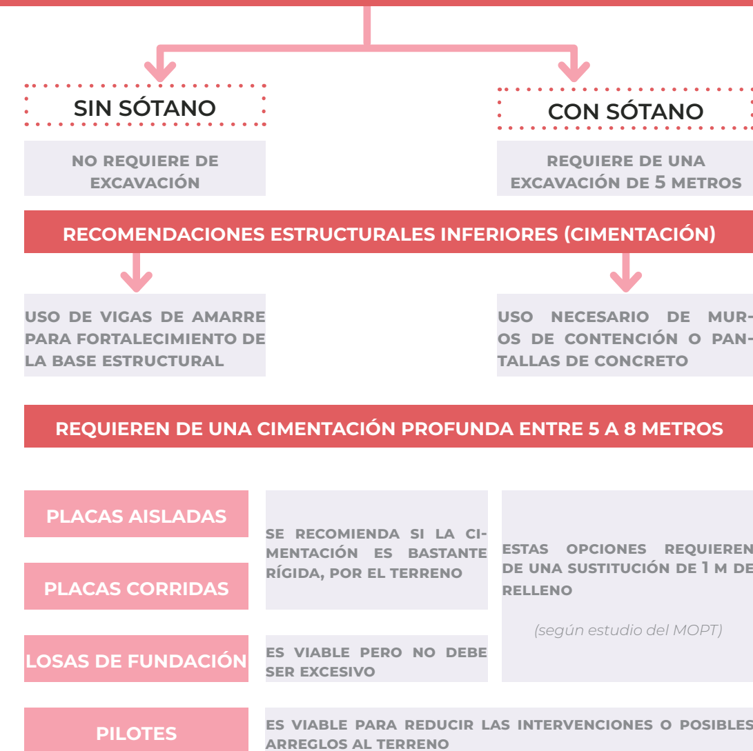
Diagrama C3.D07, Pautas para el Terreno MH. Fuente: Estudio Geotécnico, Proyecto Construcción de edificio de 10 niveles, MOPT y Código de Cimentaciones Elaboración: Propia
