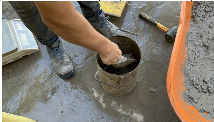
Figura 83. Procedimiento de los ensayos de peso unitario al concreto premezclado
