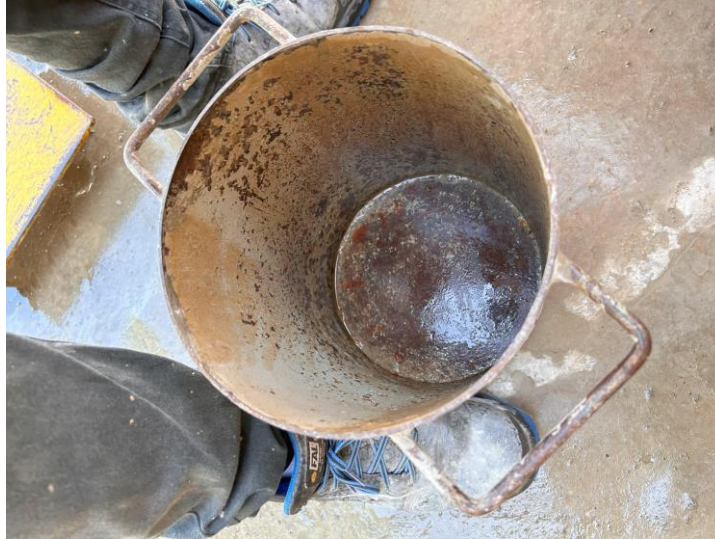
Figura 82. Recipiente para los ensayo de peso unitario al concreto premezclado
