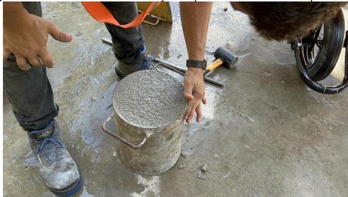
Figura 86. Procedimiento de los ensayos de peso unitario al concreto premezclado
