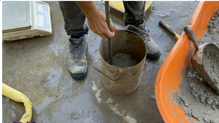
Figura 84. Procedimiento de los ensayos de peso unitario al concreto premezclado
