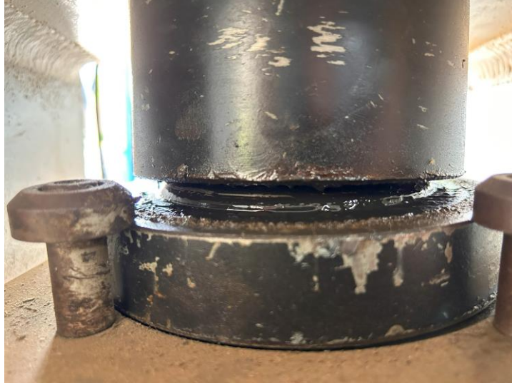
Figura 74. Equipo del ensayo de determinación de la resistencia a la compresión
