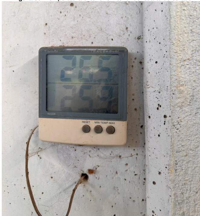
Figura 89. Temperatura exterior e interior del cuarto de curado
