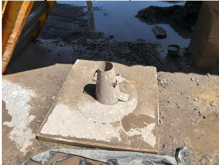
Figura 51. Moldes para el ensayo de asentamiento
