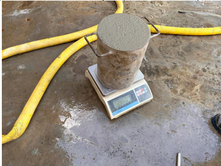
Figura 87. Procedimiento de los ensayos de peso unitario al concreto premezclado
