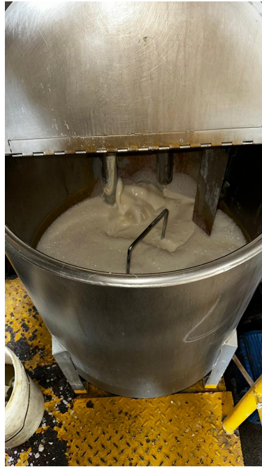
Figura 4.2: Descarga del aditivo en la línea de mezcla.
